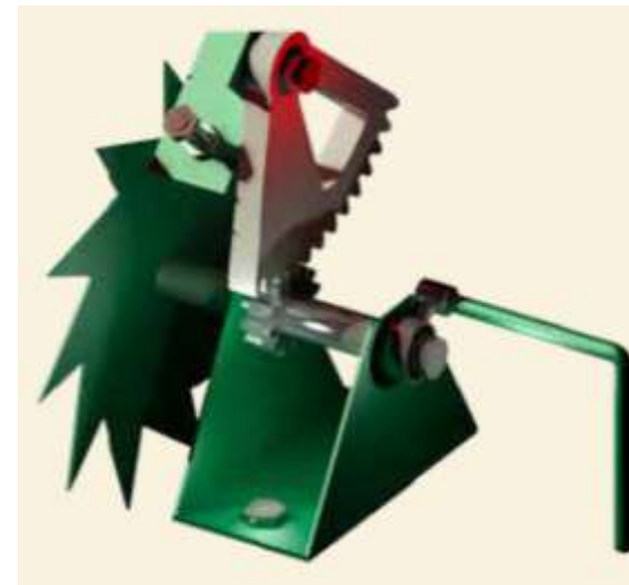
Chốt khóa cơ cấu thắt nút ở vị trí ON khi vận hành
