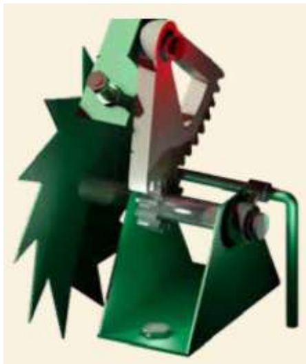
Chốt khóa cơ cấu thắt nút ở vị trí OFF khi luồn dây
