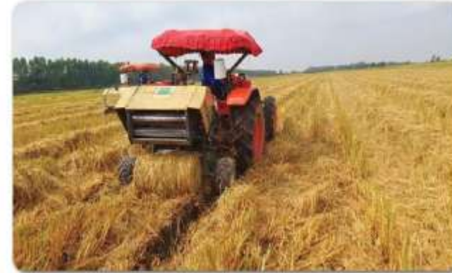
Máy cuộn rơm gắn sau máy kéo, công suất máy kéo \geq 25 HP
